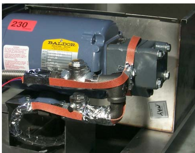
Rozlokowanie paska grzewczego na przewodach giętkich i pompie [230V PF50 (Powrót/Ssanie)].
