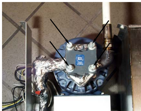
Usuń cztery wkręty mocujące pompę do silnika (strzałki).
