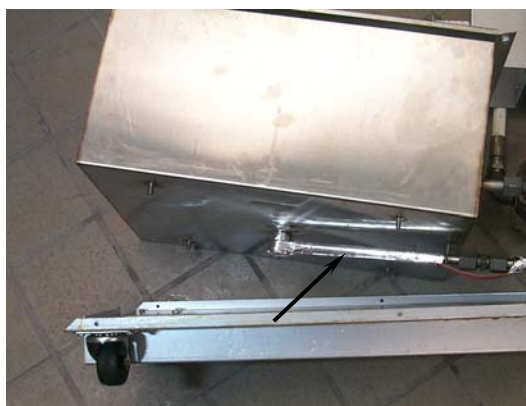
Zdejmij foliową taśmę izolacyjną, odkrywając pasek grzewczy (strzałka).
