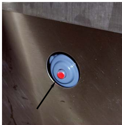
Termiczny wyłącznik przeciążeniowy silnika (strzałka) umieszczono po lewej stronie od filtra.
